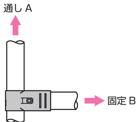
●試験条件 試験速度 5mm/min
