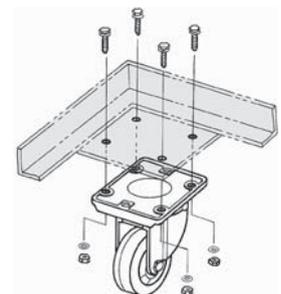
□ サンアローキャスター (プラスチック製) 軽量でさびに強く衛生的なプラスチックキャスター
