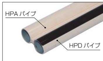
HPA と HPB (または HPD) を接着してダブルパイプが製作できます。ダブルパイプは、丸パイプ 1 本の約 3 倍の強度になります。ダブルパイプを製作する場合は、サンアロー接着液で接着してください。
