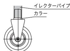
□ 固定パイプキャスター イレクターパイプ先端に直接取り付けるタイプのキャスター
