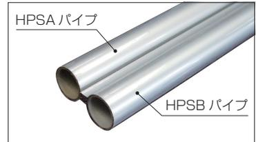
HPSA と HPSB を接着してダブルパイプが製作できます。ダブルパイプは、丸パイプ1本の約3倍の強度になります。ダブルパイプを製作する場合は、サンアロー接着液で接着してください。
