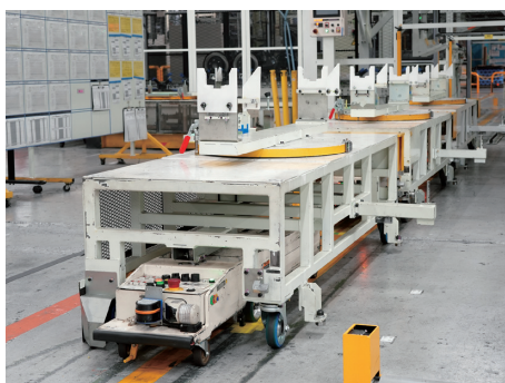
潜り込み牽引
